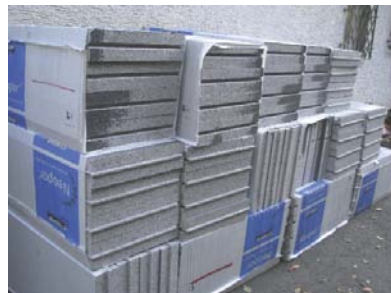
Dachbodendämmung mit Verbundplatten
